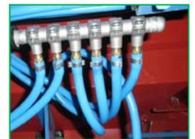
Les buses doivent être à répartition uniforme car il n'y a pas de recoupement de jet.
