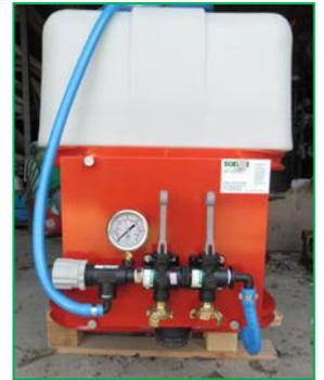
La cuve est placée à l'avant du tracteur ou directement sur le semoir, et permet d'alimenter une buse par rang. La zone de traitement est réduite des 2/3 et uniquement sur la ligne de semis (bandes de 20 à 25 cm). L'inter rangs est entretenu avec la bineuse. L'alimentation se fait par une pompe électrique branchée sur une nourrice comportant autant de départ que de rangs de semis. Une régulation permet d'avoir la bonne dose hectare.
