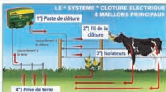
La clôture électrique est un circuit fermé dans lequel le maillon le plus faible (1 à 4) est déterminant pour la fiabilité de tout le système de clôture. Le courant ne circule que lorsque l'animal ou la végétation touche le fil, ce qui a pour effet d'envoyer le courant dans le sol où il continue à circuler en passant par les piquets de terre pour revenir à l'électrificateur.
