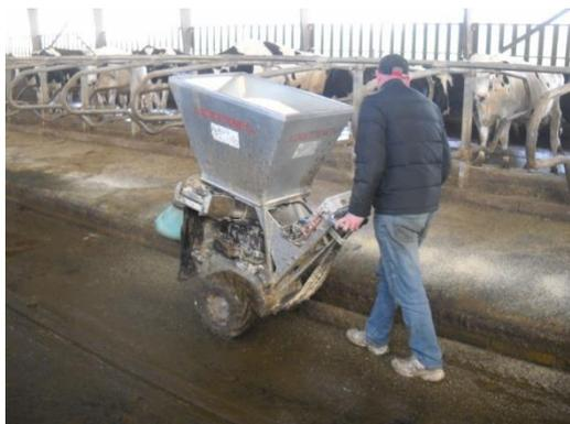
La largeur de travail de la brosse est réglée à l'aide de crans et la hauteur à l'aide d'une manivelle.
