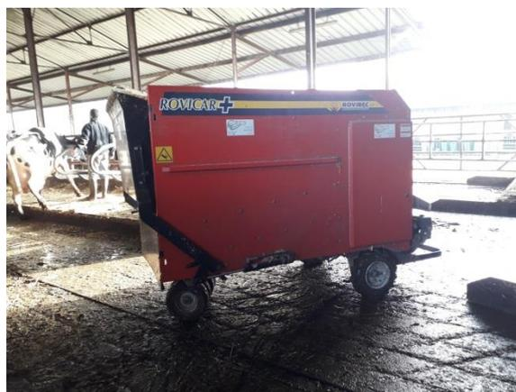
Le poste assis sera plus adapté pour des faibles volumes de paillage (capacité réduite de la trémie) ou pour une utilisation sans paillage.
